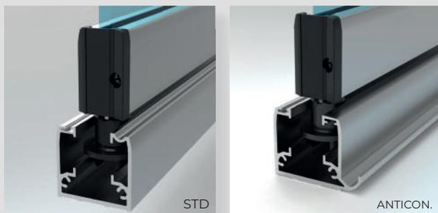
Il profilo inferiore di superfice e il profilo anticondensa hanno come caratteristica principale di permettere il drenaggio dell'umidità provocata dalla condensa, scaricandola verso l'esterno attraverso dei profili stessi.
