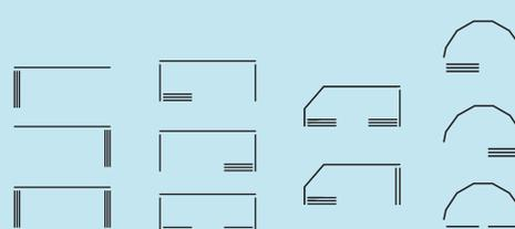
Il nuovo sistema **Seeglass-one** permette di far scorrere i pannelli in qualsiasi disposizione geometrica, aprire verso l'esterno/ interno, meccanismi di apertura dall'esterno/ interno, sezioni fisse ecc.
