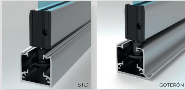
El perfil inferior en superficie junto con el perfil goterón, tienen como característica principal que, permiten una mejor evacuación de la humedad provocada por la condensación, drenándola hacia el exterior a través del perfil inferior.
