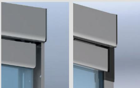
Perfiles laterales especialmente diseñados para impedir la entrada de aire al interior. Se utiliza como embellecedor y compensador lateral ante las pequeñas imperfecciones de la obra, ladrillos cara vista, etc. Fácil y rápido de instalar. Se puede instalar en sistemas colocados anteriormente.
